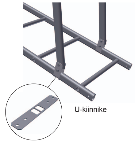
Yläkaaret asennettuna yläkaarien tukikaarilla
